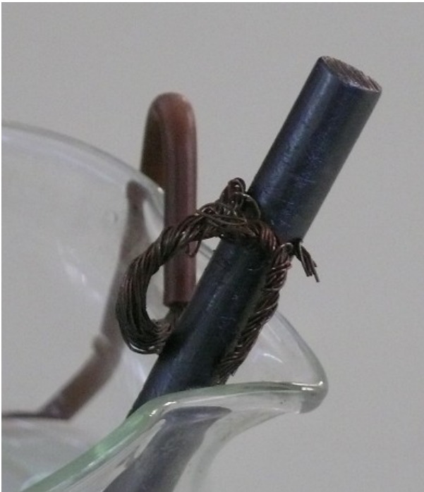
Detall del grafit amb el cable elèctric.
